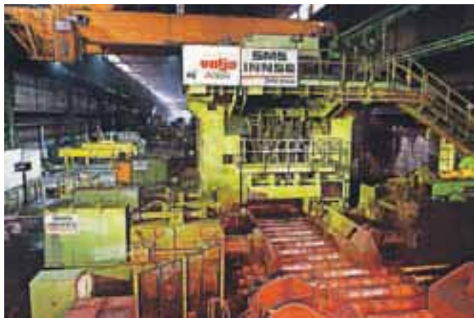
Novo valjavsko ogrodje je "srce" Acronija, omogoča izdelovanje širših in kakovostnejših plošč.
